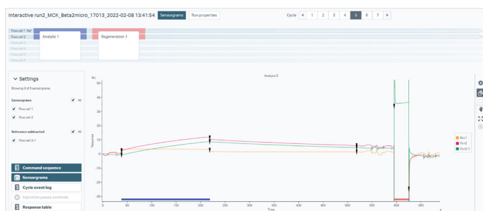
图 13. 互动式运行 的示例。每个循环都包含一个分析物进样 (可变浓度) 和一个再生步骤。然后在 Biacore™ Insight 分析软件中对全部数据 (7 个循环) 进行了 1:1 的模型拟合 (数据未显示)。(分析物: β2 微球蛋白。配体: 直接偶联到 CM5 芯片上的 β2 微球蛋白抗体)。
